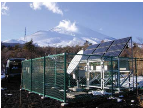
(a) 太陽電池電源・衛星テレメータ観測点。
