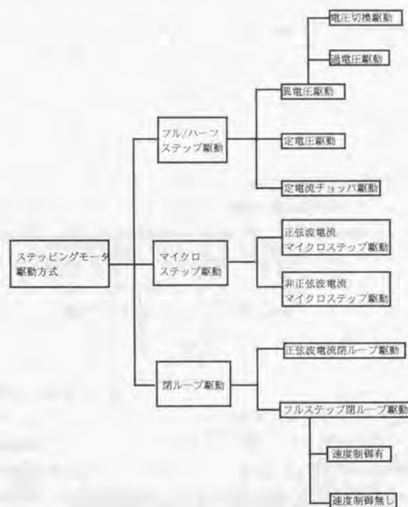
図1-19 ステッピングモータの駆動方式の分類
