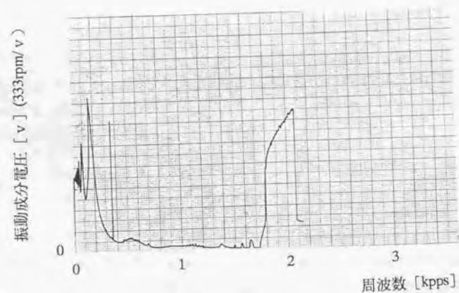
(b) 3相ステッピングモータの振動特性
