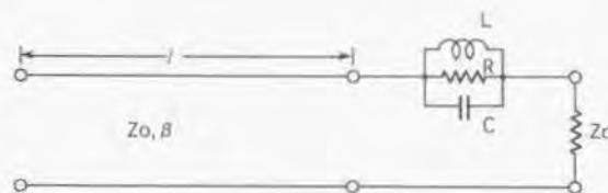
図3.20 ゲート端から誘電体共振器を見た等価回路
