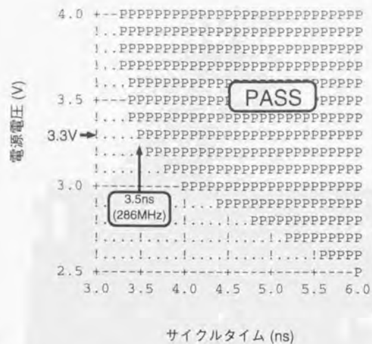
図5-7 サイクルタイムと電源電圧に対するシュムープロット
