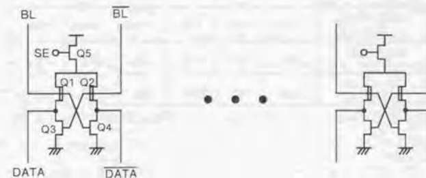
図付-12 センスアンプ回路
