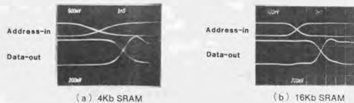
図付-3 4Kビットおよび16KビットSRAMの入出力波形
