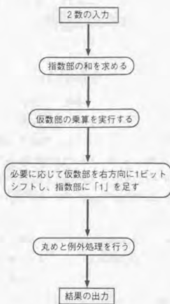
図5-1 浮動小数点乗算の実行手順
