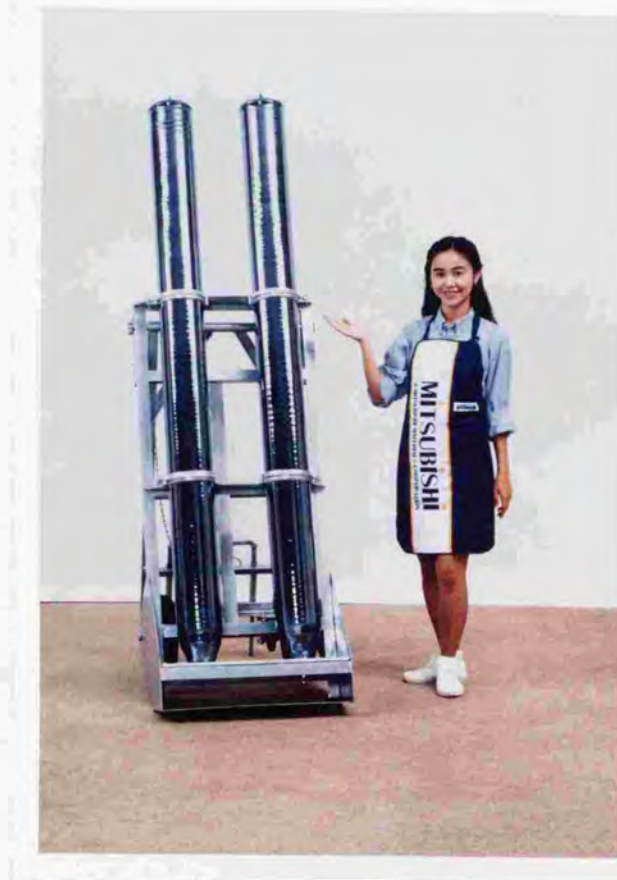
図6.2.1 開発した連続引上法による中口径単結晶の写真
