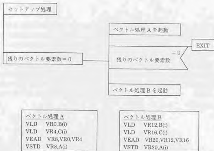
図 4.7 A(i)=B(i)+C(i) のコンパイラによる高速化方式
