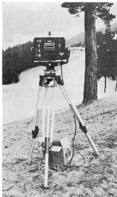
写真1 レンジマスターⅢ型による測距
