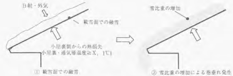
(a) 小屋裏・通気層温度 \geq X_1 [°C] となった場合に屋根面積雪の融雪発生
