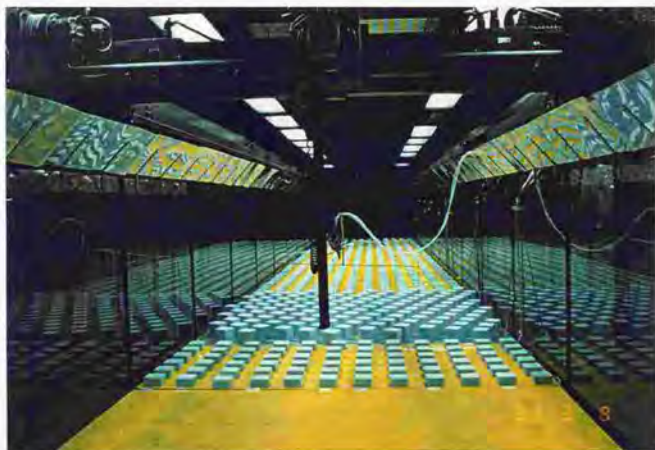
写真3.1.1 模型の設置状況 (街区高さ H = 1.25L 、風向 \theta = 33.75^\circ )
