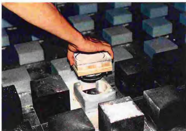
写真 2.6.2 粒子発生器の設置状況
