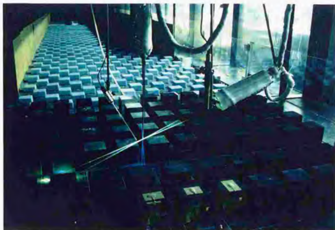
写真 2.6.1 レーザー流速計による測定状況
