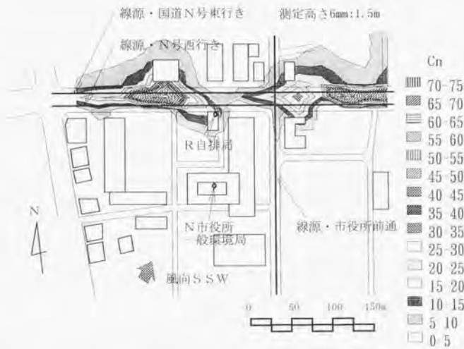
図 3.0.1 観測点の配置およびN市役所周辺の無次元濃度分布 風向SSW
