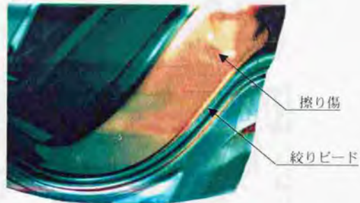
図 7.1 絞り成形における絞りビード通過材料の傷痕
