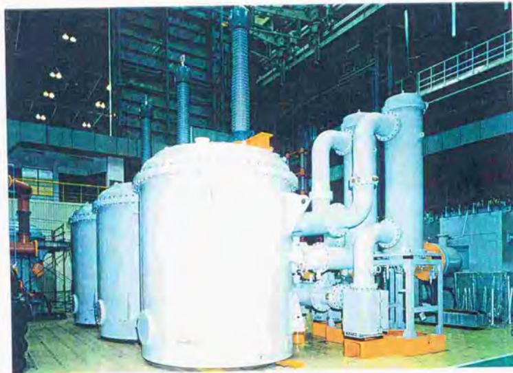
図6.5 275kV, 150MVAガス絶縁分路リアクトルの外観写真
