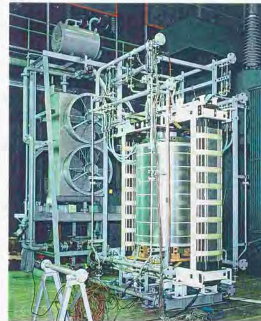
図2.15 実規模冷却モデルの外観
