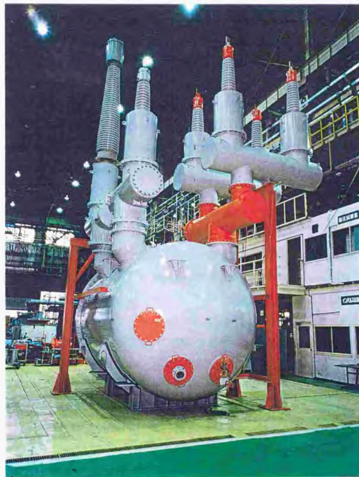
図4.12 275kV, 300MVA0号器
