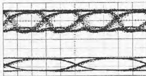
図 3.21 3 R 機能回路の出力アイパターン
