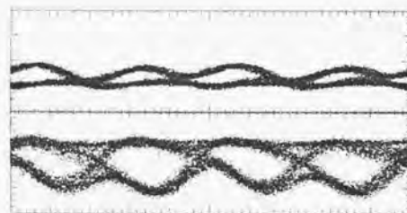
図 5.18 40 Gbit/s アイパターン 上段:40GHz フォトダイオード 下段:集積化受光回路
