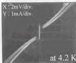
図4-29. 改良された「in-situエッジ接合形成法」により作製した1チップ上12個のエッジ接合の電流電圧特性を重ね合わせた図[67]。
