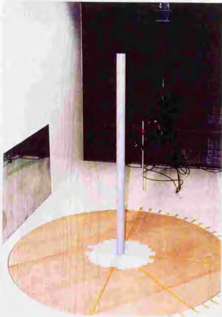
図-4.5 圧力模型を風洞に設置した様子
