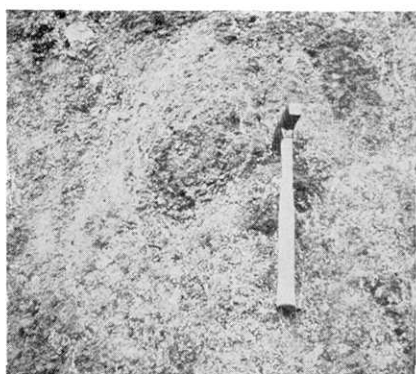
第11図 Loc. 24 の滑落崖に現われた熱水変質によって粘土化した岩盤。
