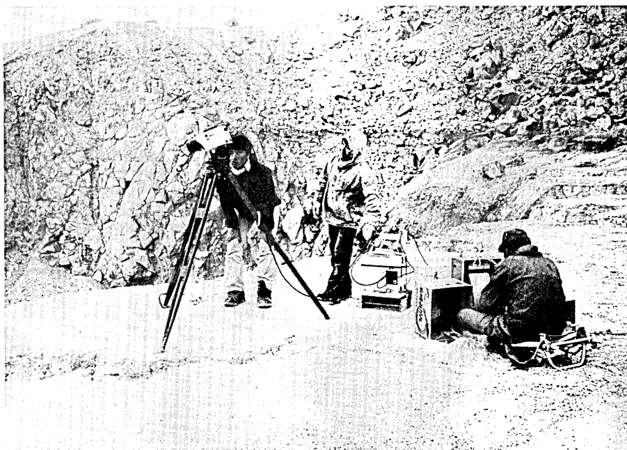
第8図 水釜火口内Q点に設置した赤外放射温度計(8月29日)
