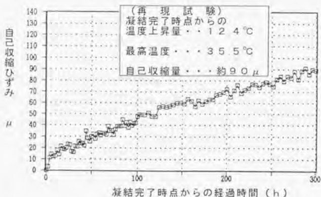
図-4. 16 2P現象再現試験における自己収縮（反応収縮）——ケースb)
