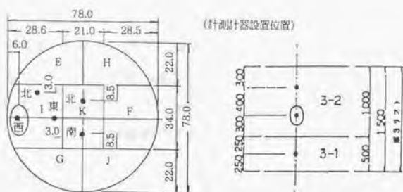
図-2. 8 温度、応力、拘束ひずみ計測位置の例 (3 P主塔基礎)
