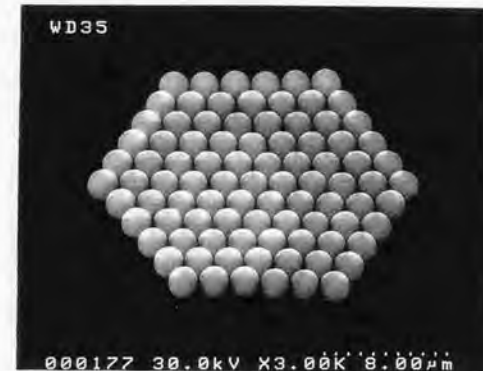
(a) N=6の2次元フォトニック結晶（微小球91個）
