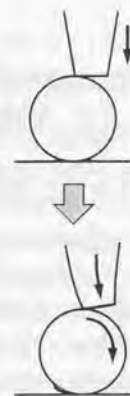
図5.4.2 偏心押し込みによる付着面の剥離
