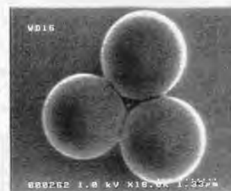
2 \mu\text{m} (a) 粒子間不純物
