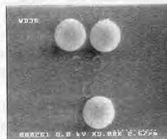
3 \mu\text{m} (b) 固着していた粒子を 引き剥がしたところ
