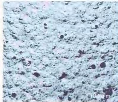
図1.6 仕上げ面の小穴
