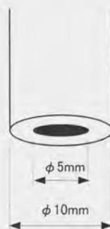
図 3. 26 加工速度比較テスト電極 (材料: Cu)
