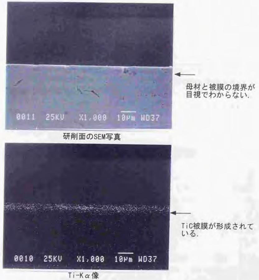
図5. 17 放電表面処理面の断面写真
