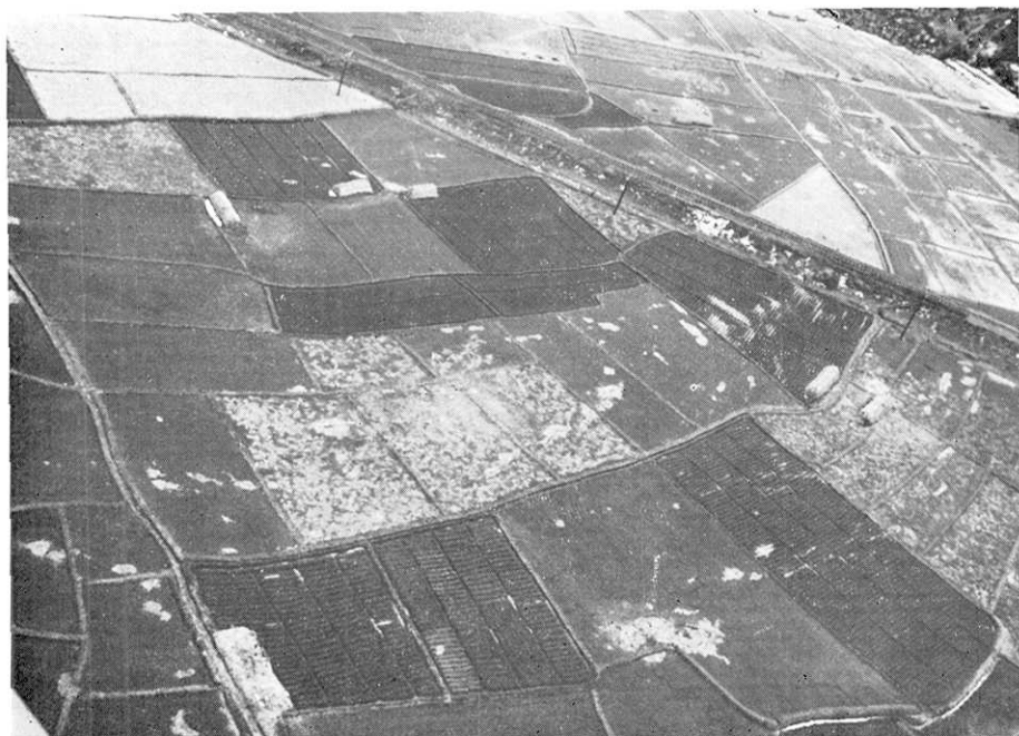
第 19 図 亀沢東方の水田中の噴砂の分布. 旧河川の流路の方向に平行に配列している.
