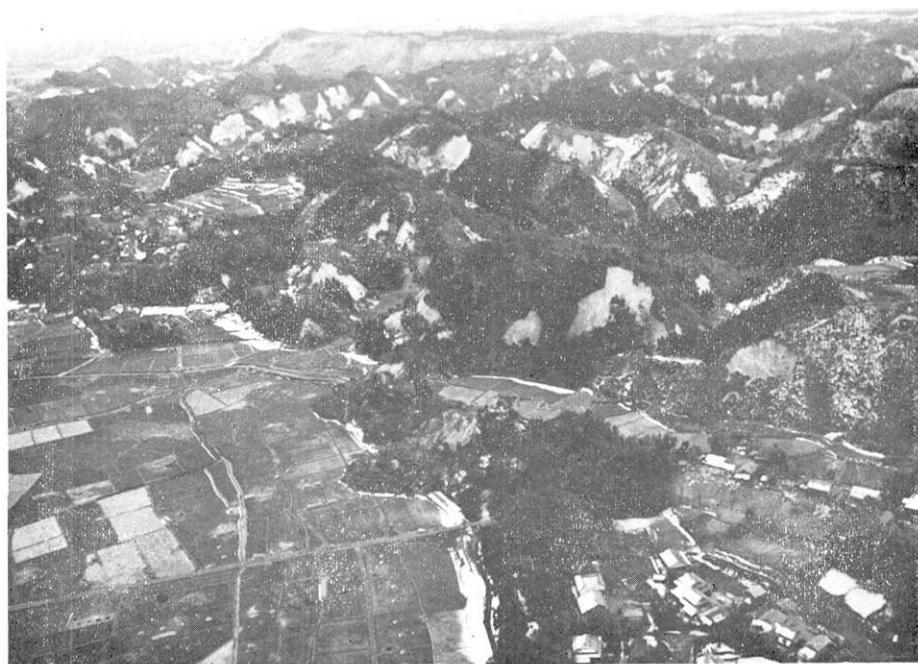
第 17 図 幣田東部の崖崩れ (中央)。画面中央上端の崖は桃ヶ迫北方の弧状の丘陵。その頂部には飯盛山溶岩が、崖面の大部分には京町層・池牟礼層が露出する。
