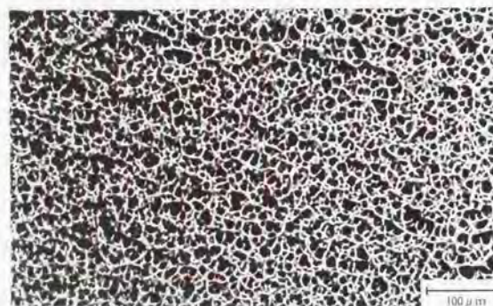
図 7-13 高減衰ゴムダンパの内部構造の例
