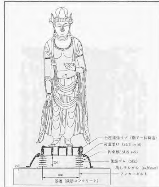
図6-31 免震装置の設置例
