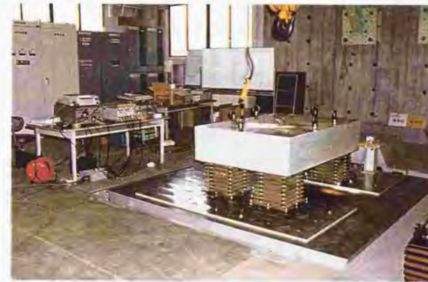
図 7-8 振動実験中の供試体
