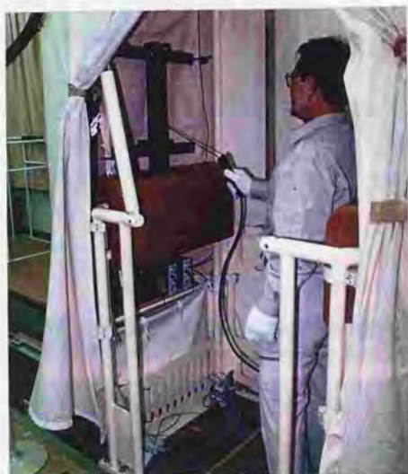
写真 5.5 溶接作業の限界を求める実験
