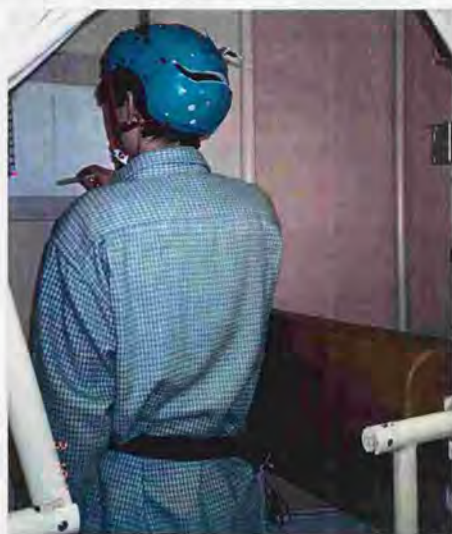
写真5.4 直線描き作業の限界時における頭部および腰部の変位測定
