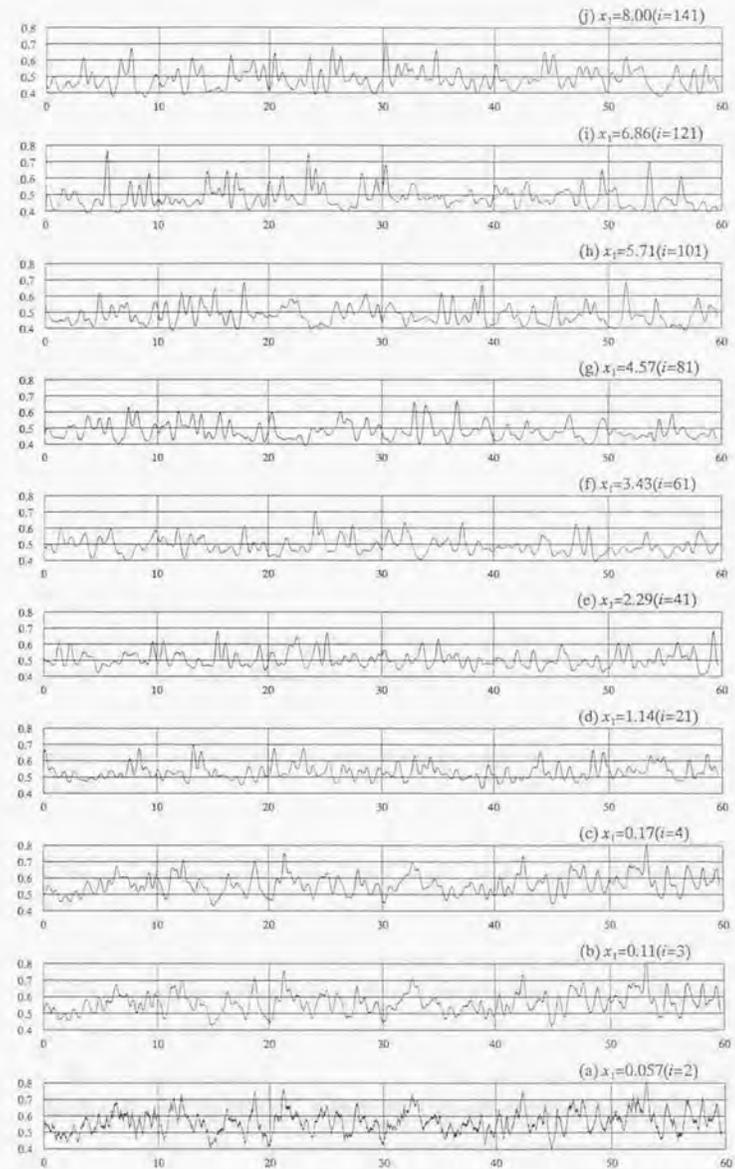
図 5.29 風速の時刻歴波形の主流  $x_1$  方向の変化 (ケース 2 :  $u_1$  成分,  $x_3=0.029(k=2)$ )
