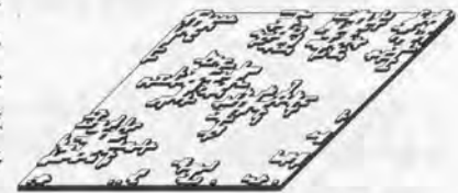
図 3-23 MBE 成長条件下のシミュレーションで得られたクラスタ。 \phi = 20kT , \Delta\mu = 36kT , \epsilon = 0.5
