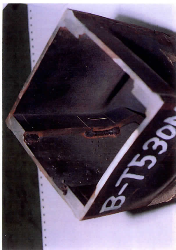
写真 3.10(b) 裏当て金の溶接状況
