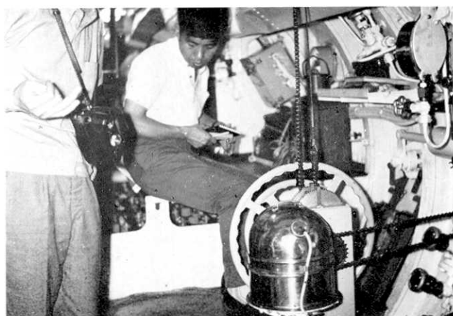
第8図 「よみうり」号船内の状況，操舵輪の後方台上に重力計を設置した。
