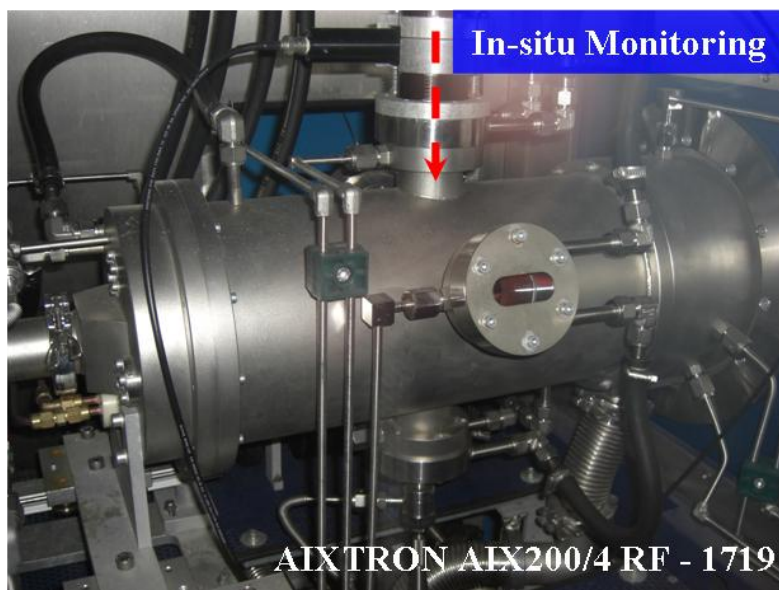
Fig.2-2 MOVPE 装置反応炉の外観と Epitune の光入射位置
