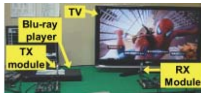
Fig. 2.16 非圧縮 HD 映像を無線伝送するデモンストレーション
