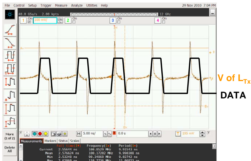
Fig. 4.11 送信回路の出力波形
