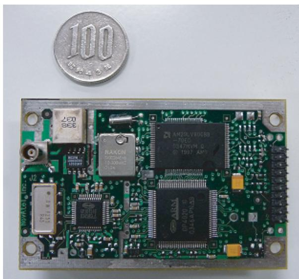
図 1.2: オープンソース GPS を組み込み可能な SuperstarII GPS 受信機
