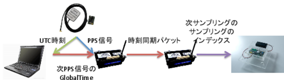
図 3.10 GPS 受信機, PC, シンクノードの接続
