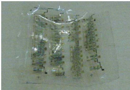
図 B.1 シルクフィブロインの歪みの違い . (a) PDMS に貼り付けてプロセスを進めたデバイス . (b) PDMS をスピコートしてプロセスを進めたデバイス . スピコートすることでフィルムの歪を抑えることができる .
