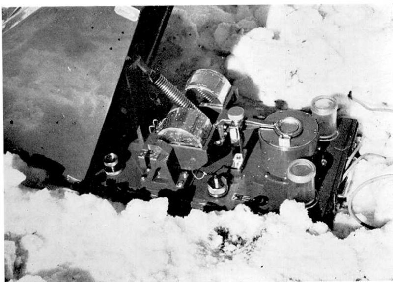
Fig. 16. HES 上下動換振器 ( T_1 = 1.0 \text{ sec} ) (凍土層に氷着した板の上に設置されている)
