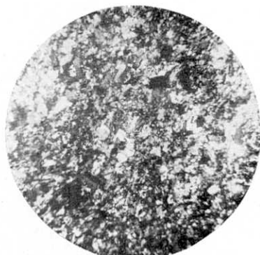
第 22 圖 ヘレフリンタ様壓碎岩。 (薄片 c. 67. 第 7 圖 Loc. 186.)
