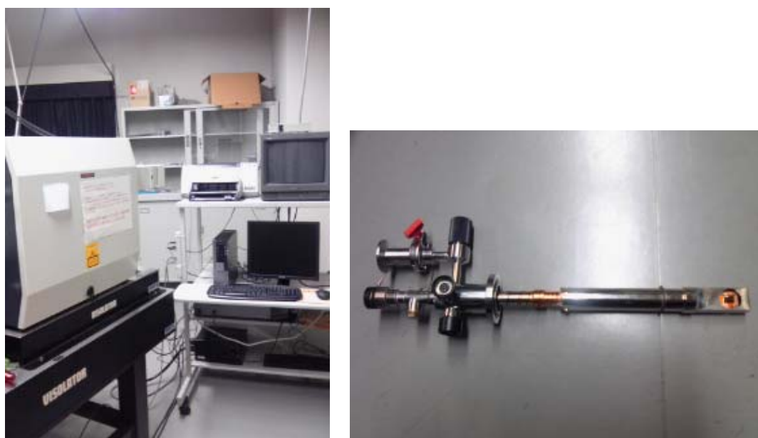
図 2-11 顕微ラマン分光システムと顕微用 He クライオスタット
