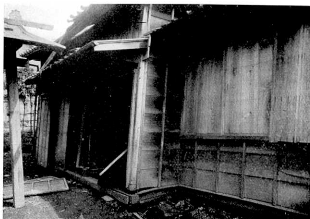
第 20 圖 正面方向のみへ加力中 (約 4 トン) 裏口, 土臺と柱と離れる
