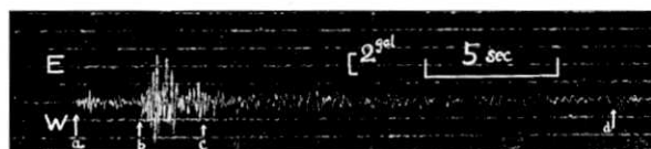
寫真第 2 昭和 12 年 2 月 17 日午後 10 時 32 分頃の地震による天守閣第 4 層床の振動記録 ab 間を初期微動部、bc 間を主要動部 cd 間を終期部とす (第 8,9 圖参照).
