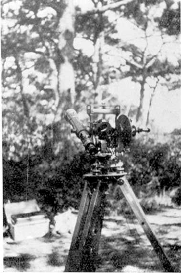
a) 測定に使用せる水路部型磁氣儀 Earth Inductor and Striding Declinator.
