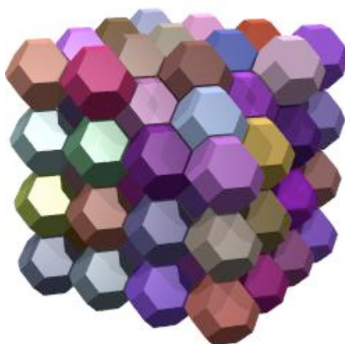
図 22 ウィグナー・ザイツ胞
