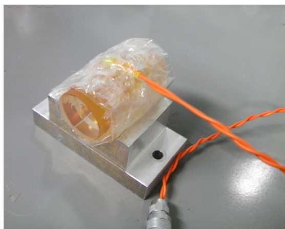
図 6.12: サーミスタを取り付け、断熱材を巻きつけた状態の試料 (BK7)。
