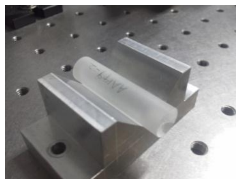
図3：試料（サファイア）の写真。直径、長さはそれぞれ 10 mm、40 mm である。また、試料は c 軸が長手方向と一致するようにカットされている。
