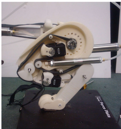
図 1.22 チータの脚を模倣したロボット [22]
