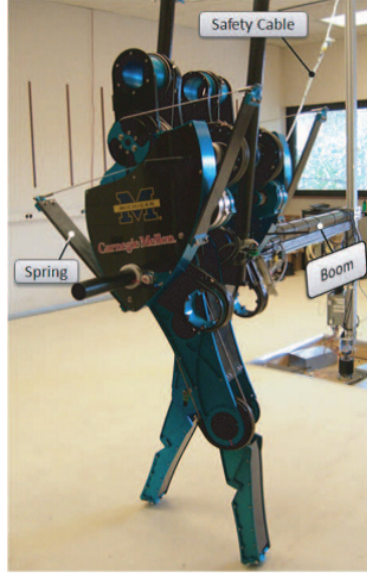
図 3.3 SLIP モデルを利用した 2 リンク歩行ロボット
