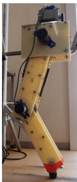
図 6.2 製作中の一脚跳躍ロボット
