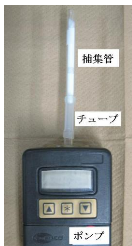
図 2-2. 捕集管と ポンプの接続
