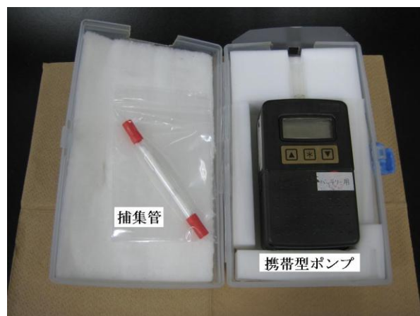
図 1-2. 防音ケース内の器具（ポンプ・捕集管）
