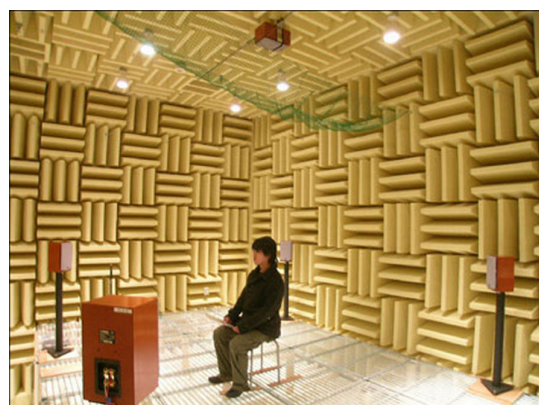
Fig. 2.6 6チャンネル再生系
