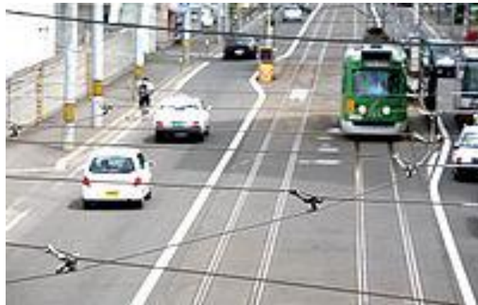
図 2-1 架空電車線方式
