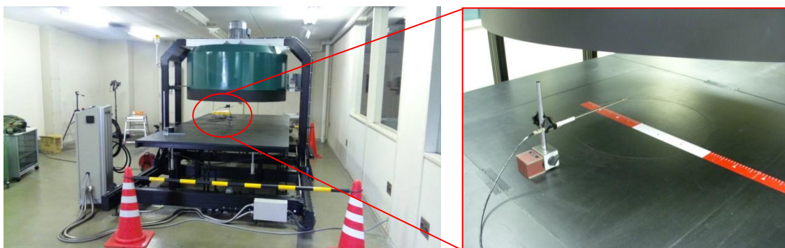
図 3.2.2 風速計設置の様子
