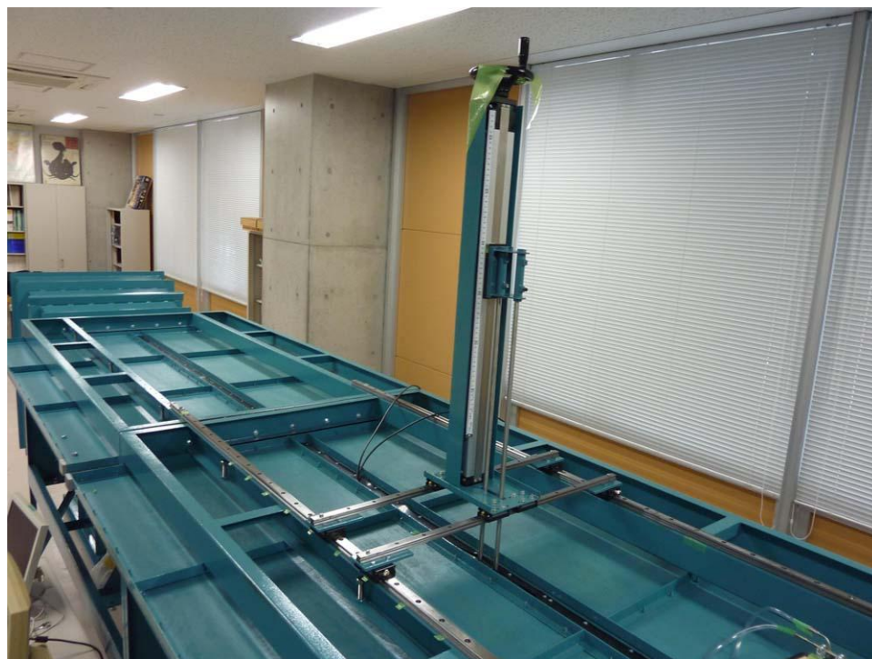
図 4.1.4 複数ファン風洞上部のトラバース
