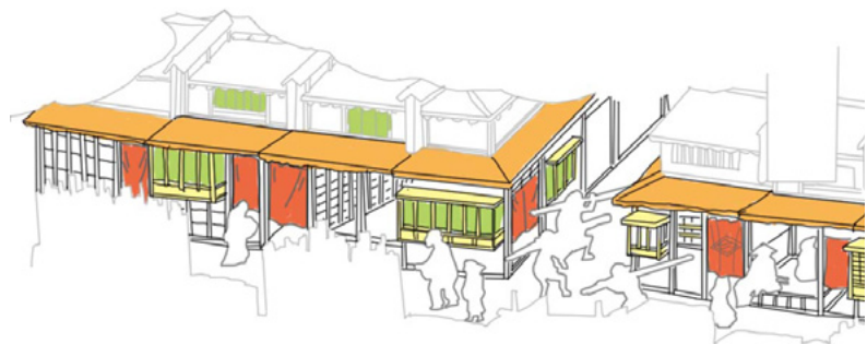
図 4.1-12 張り出した庇、暖簾、格子、簾が重なる町家
