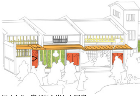
図 4.1-8 庇が張り出した町家
