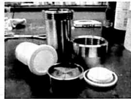
図 4.8 volborthite の合成法. 第一ステップで沈殿法を, 第二ステップで水熱法により試料をアニールする過程を示す.
