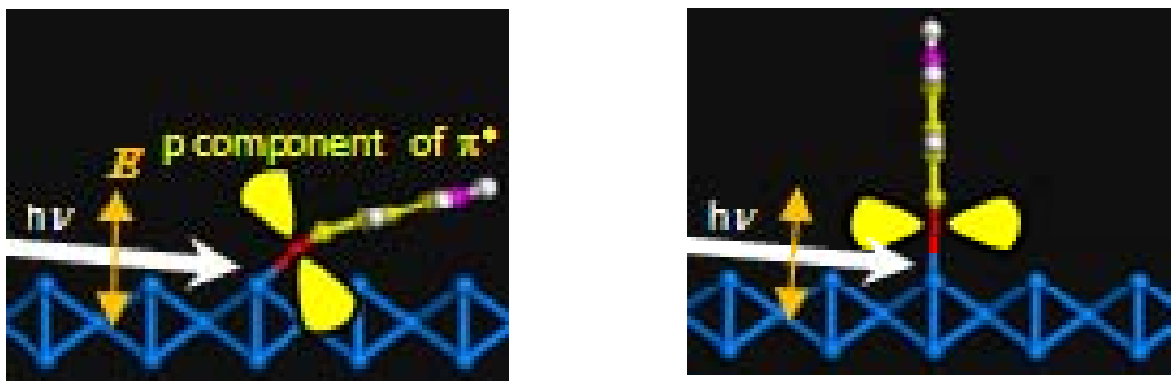
図 5-14 XAS に関する参考図。入射光の偏光が[110]方向を向いている場合、左図のように分子が表面に対して水平ならば、 \pi 対称性を持つ非占有軌道への励起が起こりやすいため、 \pi^* ピークが現れる。一方右図のように分子が表面に対して垂直な場合には \pi^* ピークは現れない。入射光の偏光が[001]方向を向いている場合や \sigma^* ピークについても同様の考え方で分子の配向を知ることが出来る。
