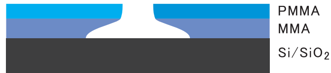
図 2.3. 現像後のレジストと基板の断面の模式図。PMMA/MMA 2 層レジストの場合。
