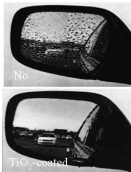
図 1.10 超親水性を示す \text{TiO}_2 コートされた車のサイドミラー [20]。
